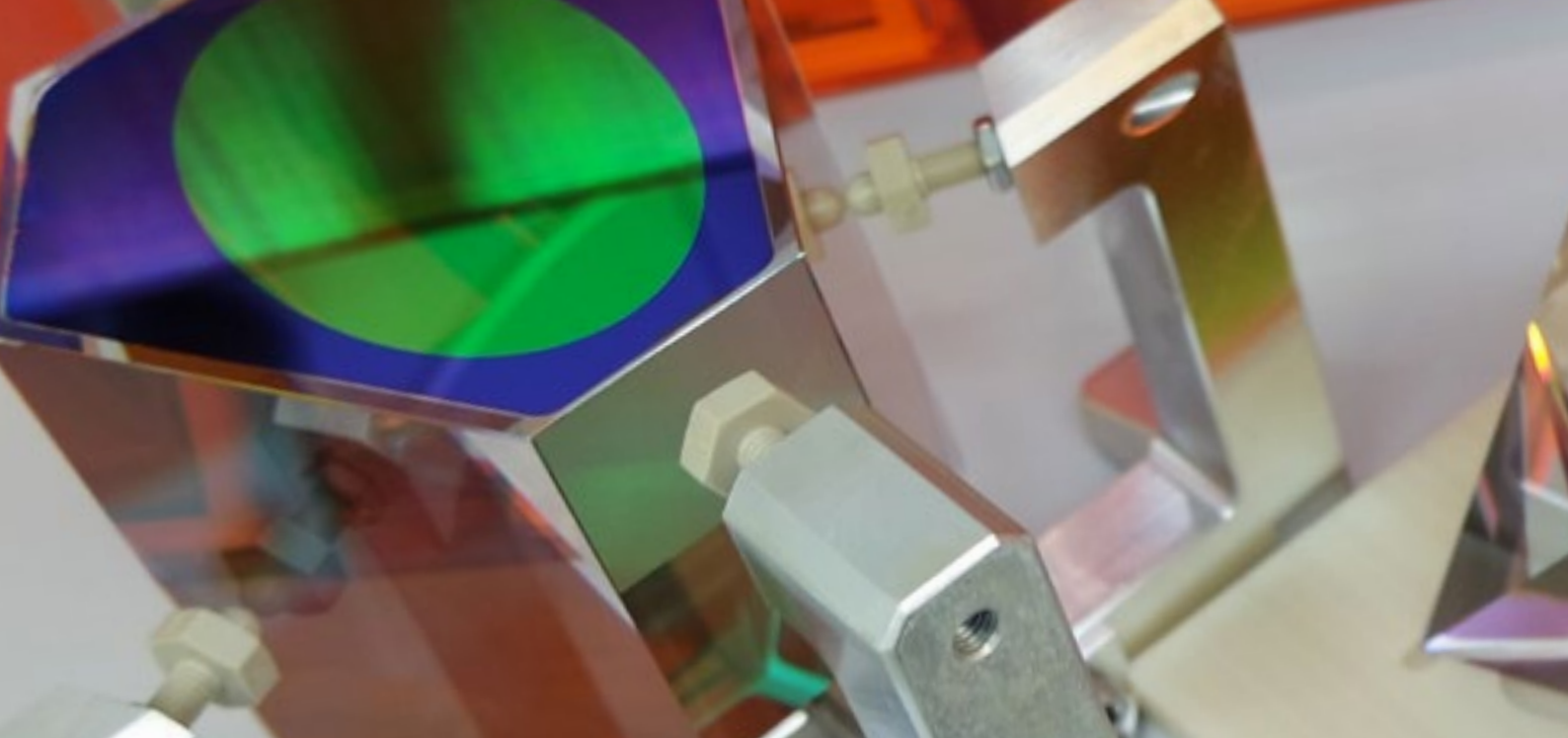
[1] Prisma mit Schwarzapertur und Entspiegelung innerhalb der Clear Aperture. Prism with black aperture and AR coating inside the clear aperture.
