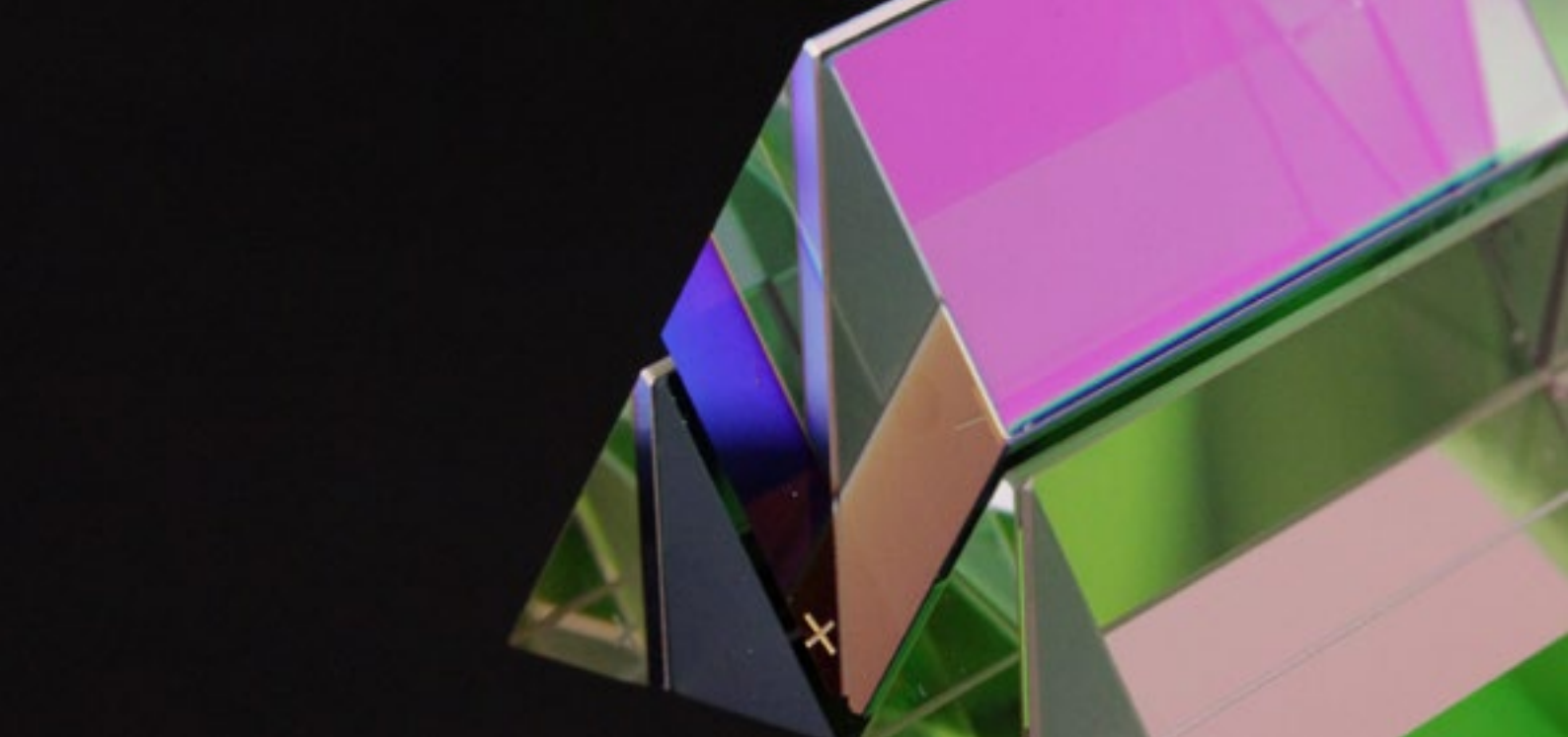
[1] Vollständig aufgebauter 4-Kanal-Strahlteiler. Mounted 4-channel beamsplitter.
