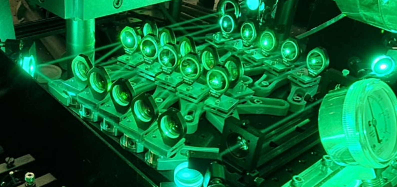
[1] Spiegelkompressor welcher bei höchsten Durchschnittsleistungen betrieben wird. Chirped mirror compressor operating at highest demonstrated average powers.
