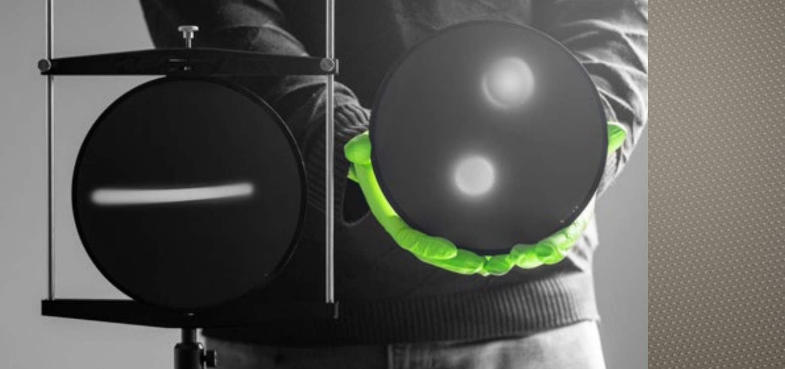
[1] Linien- und 3D-Doppelball-Projektion mit 40° FOV MLA. Line and double sphere with 40° FOV 40.
