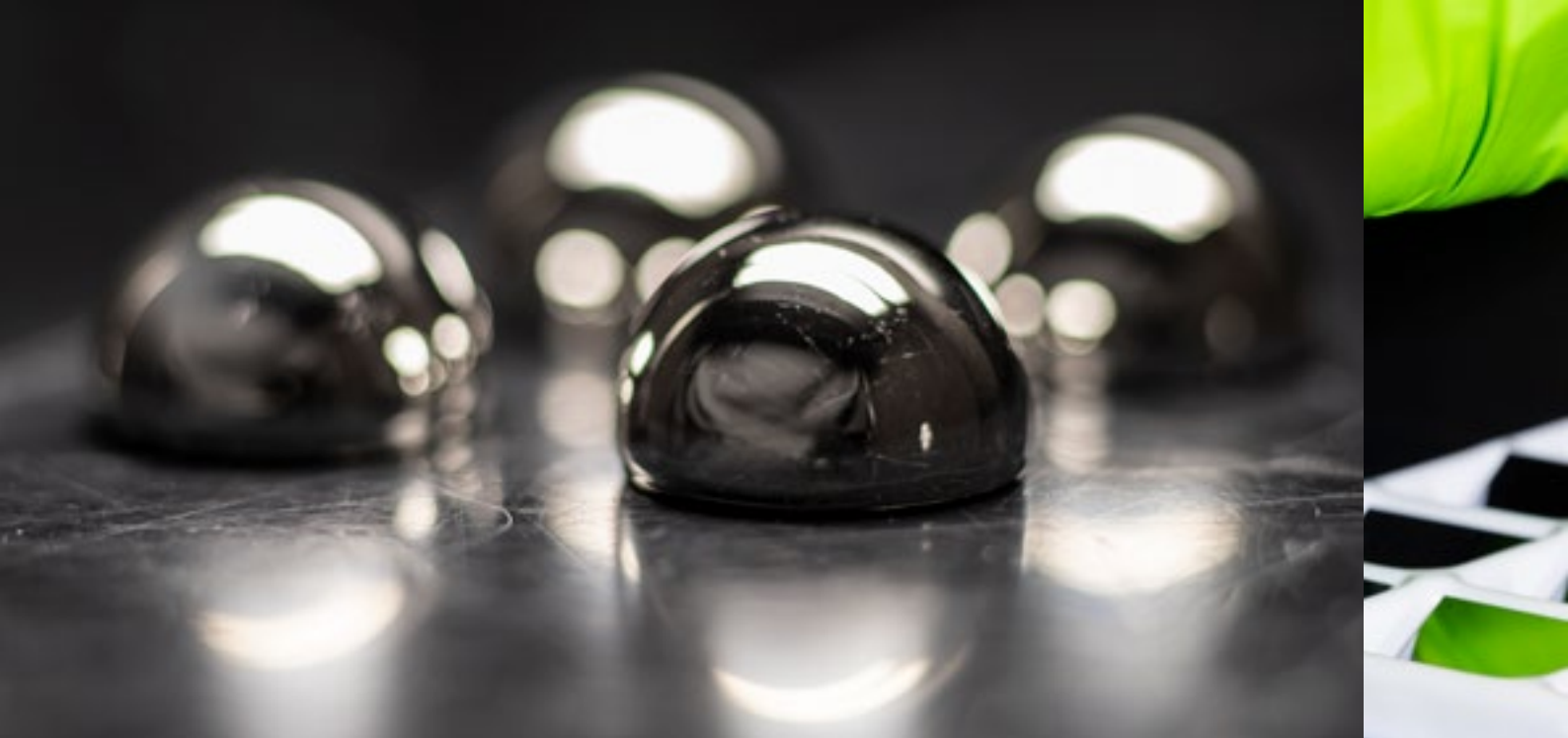
[1] Konforme Metall-Beschichtung von stark gekrümmten Spiegeln. Conformal metal coating of highly curved mirrors.
