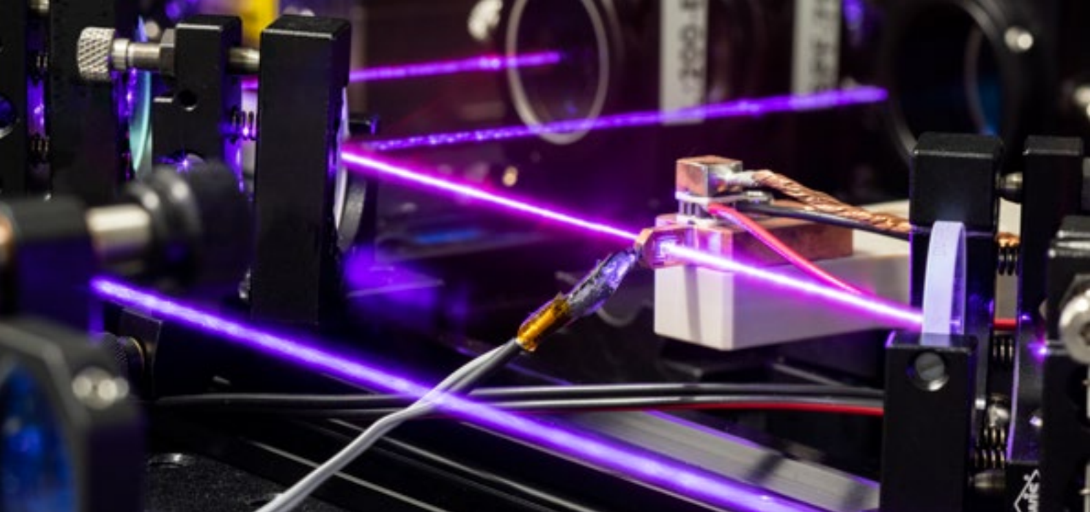
[1] Experimenteller Aufbau für Holografie mit undetektiertem Licht. Experimental setup for holography with undetected light.
